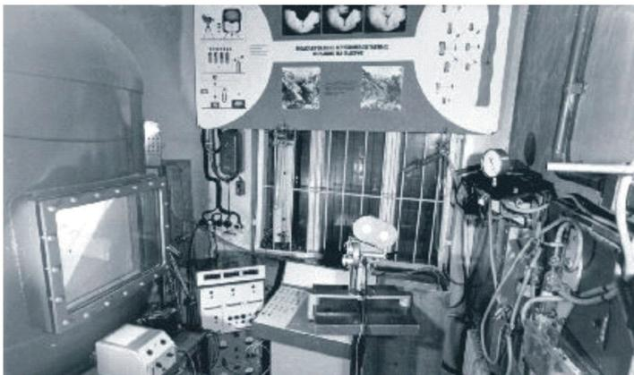
Лабораторный стенд для моделирования крупномасштабных взрывов на выброс
