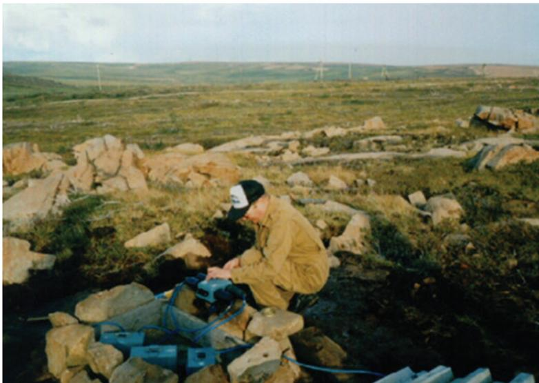
**Рис. 2.** Установка сейсмометров СМ-3КВ-Э на площадке S1 (Норильск). В кадре Е. А. Сутулов, 2000 г.
