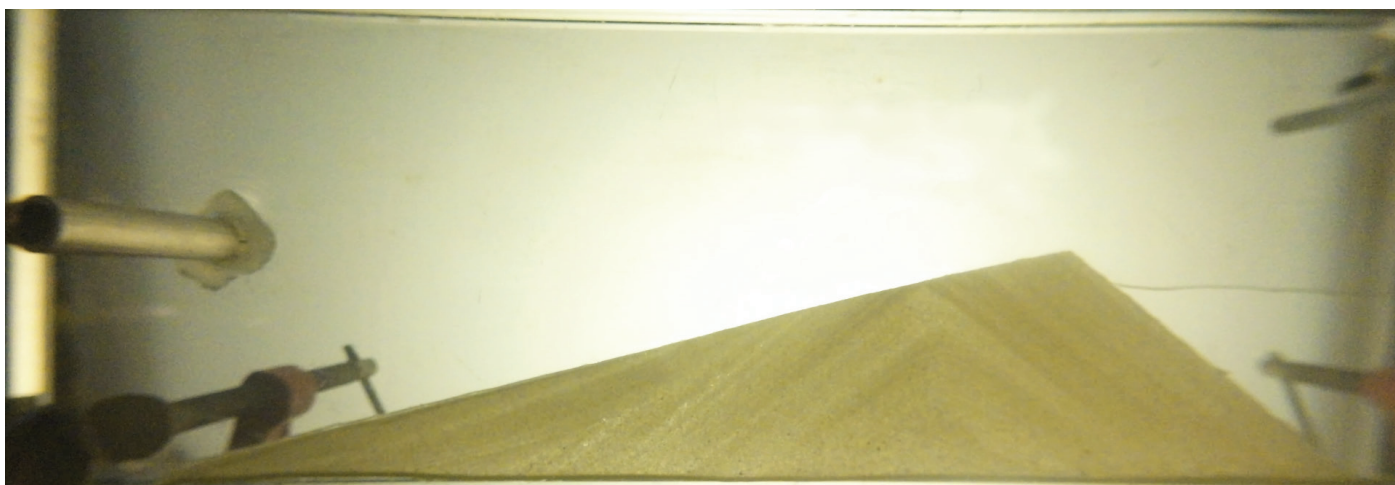
Рис. 7. Геометрия «дамбы» после смыва вершины
