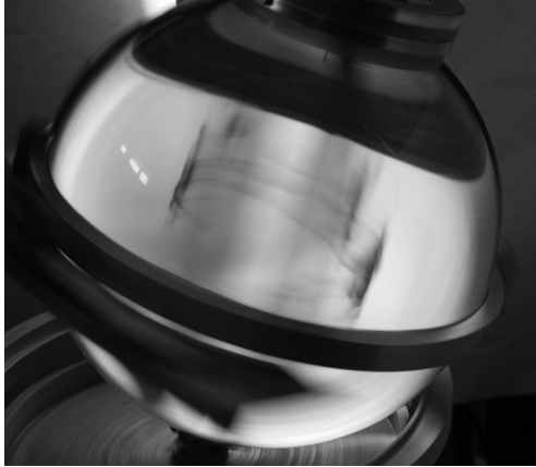
Рис. 2. Цилиндрические структуры во вращающемся сосуде.
