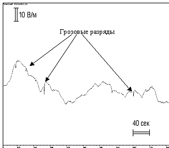
Рис. 6. Пример регистрации грозовых электрических разрядов с помощью ИНЭП
