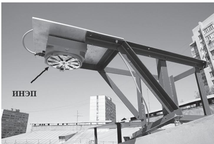
**Рис. 3.** Расположение флюксметра ИНЭП на установочной площадке
