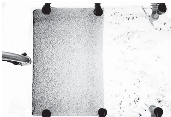
Рис. 3. Пористая среда с осевшими в ней частицами
