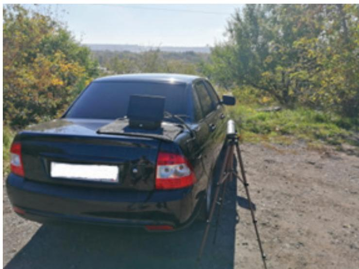
Рис. 3. Мобильный пункт наблюдения (микрофон установлен в защитном экране)
