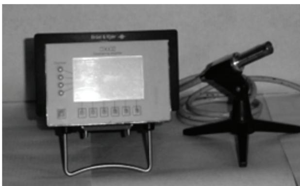
Рис. 2. Измерительный микрофон 4147 с усилителем 2690А-OS2 фирмы Брюль и Кьер
