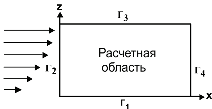
Рис. 1. Схематическое изображение расчетной области. Символами « \Gamma » обозначены границы области. Слева стрелками отмечено втекание в расчетную область стратифицированного по вертикали горизонтального ветра
