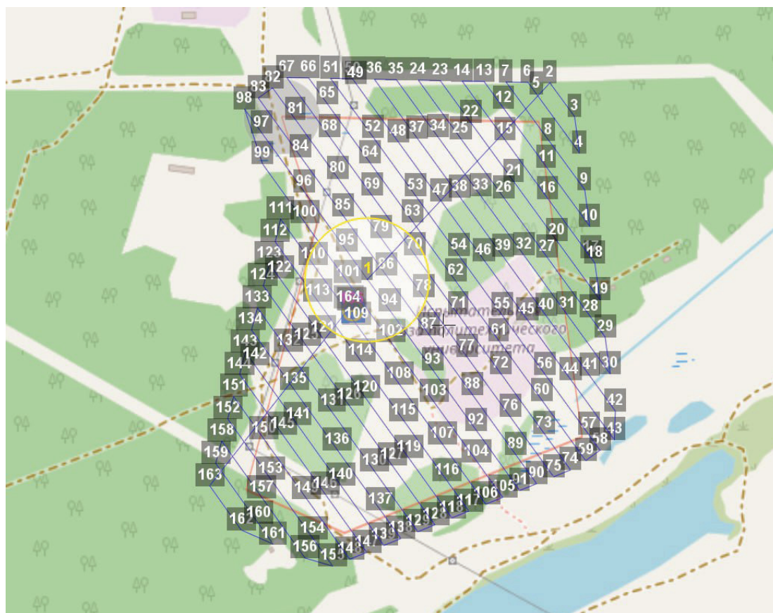
Рис. 3. Предварительное полётное задание. Кругом обозначена точка ожидания, числами – последовательность, в которой автопилот будет следовать на соответствующие точки; галсы изображены линиями
