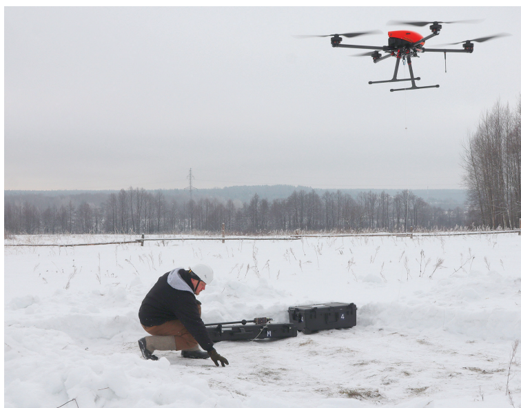
Рис. 2. Взлёт носителя Геоскан 401 и процедура присоединения магнитометра
