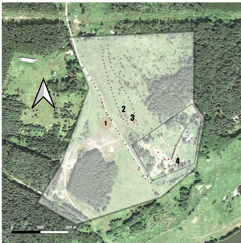
Рис. 1. Схема размещения оборудования и точек наземной съёмки (крест), а также позиции опознавательных знаков (ромб). Пунктирной рамкой отмечена граница «Загородного полигона». Сплошной серой границей отмечена зона полётов. Символами 2, 3, 4 отмечены MBC SmartQuantumMag, MBC GSM-19, опорная станция ГНСС OC-113 соответственно. Точкой с обозначением 1 отмечено место взлёта и посадки БПЛА Геоскан 401
