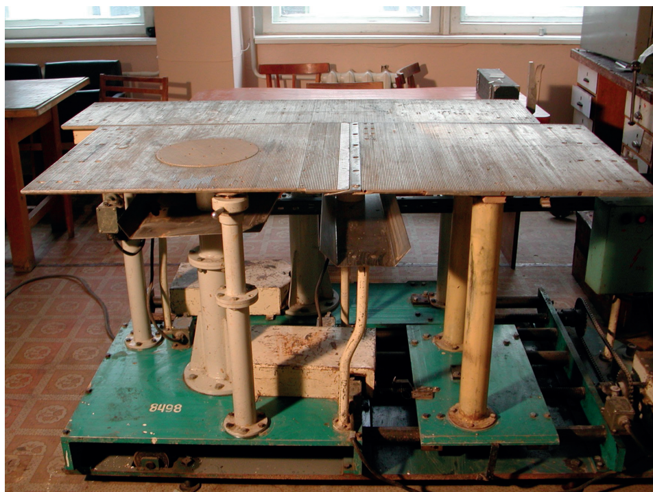
Рис. 4. Установка «Разлом» для моделирования тектонических процессов в естественном поле силы тяжести
